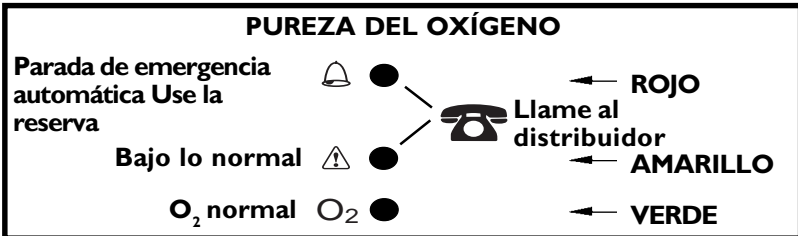
FIGURA 8 - PANEL DE CONTROL CON INDICADOR DE O 2
